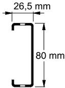
**Anschraubprofil 80x26,5 mm**
